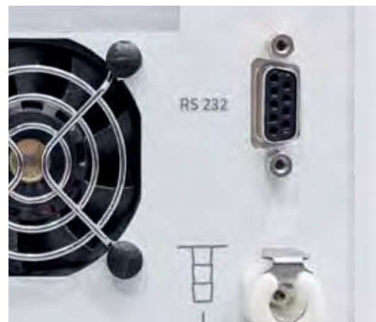
Interfaz RS 232 de serie para la integración del sistema en procesos
